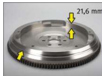
Рис. 2: OE № 93186460 / 5616016 с выемкой по окружности, глубина маховика 21.6 мм.
