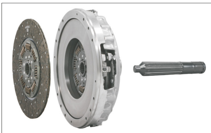
Рис. 1: Сцепление с двумя ведомыми дисками и центровочный инструмент.
