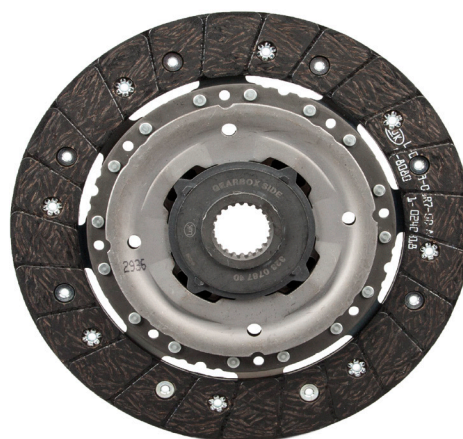
Рис. 2: Диск сцепления с демпфером на втулке (диаметр 228 мм или 240 мм)
