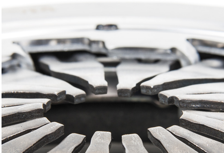
Рисунок 1: Неравномерность высоты пальцев диафрагменной пружины неустановленного сцепления
