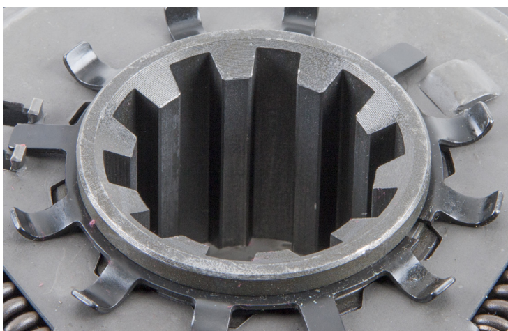
Рис. 2: Фосфатированные ступицы необходимо смазывать
