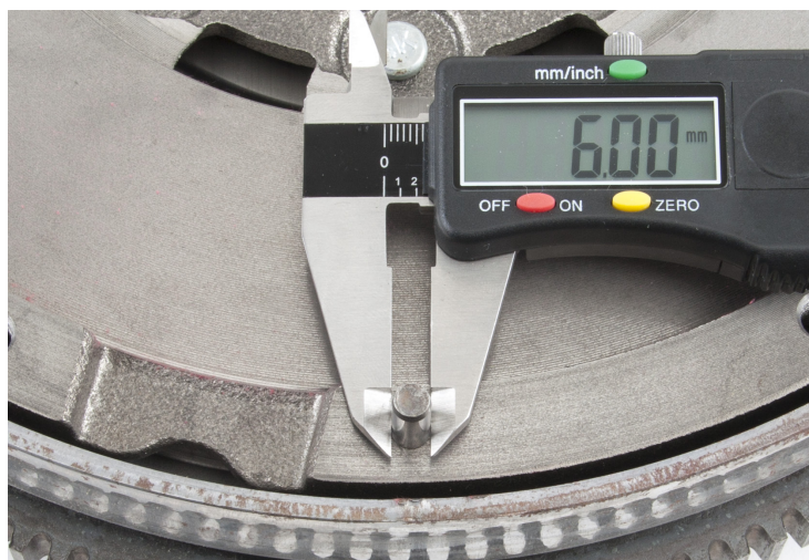
Рис. 1: Измерение диаметра центровочной шпильки
