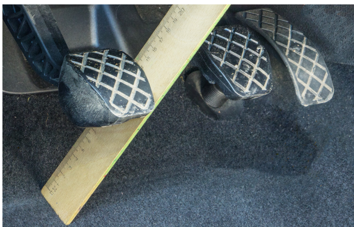
Рис. 1: После замены сцепления отрегулируйте ход педали.
