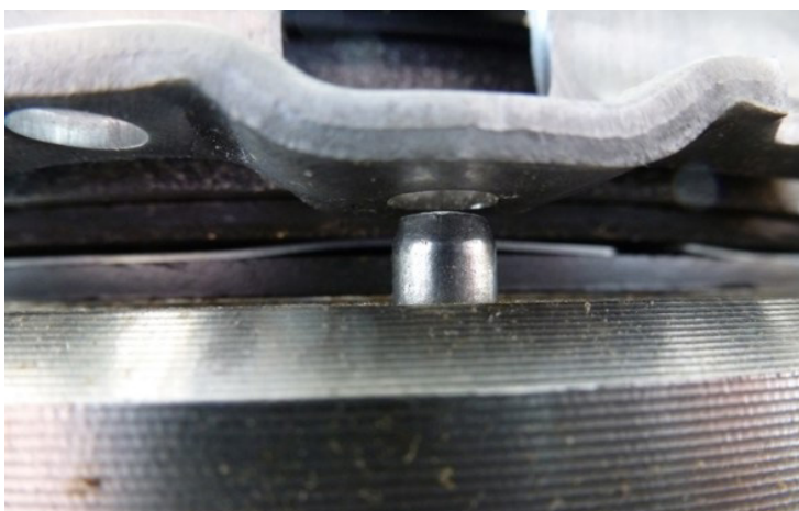
Рис. 1: Центрирующие штифты не вставляют в отверстия во время установкмонтажа
